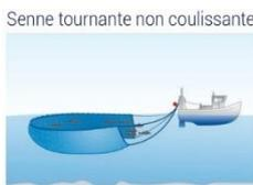
La senne tournante non coulissante est constituée d'une nappe de filet de faible maillage mais de grande résistance, prolongée aux extrémités par des ailes. Ce type de filet, dont la poche centrale est en forme de cuillère, permet de retenir le poisson le temps que les deux ailes soient hissées simultanément à bord.
