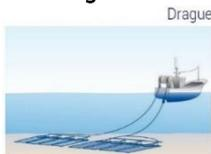
Leurs filets en forme de poche sont fixés à une armature métallique en croissons. La barre de traction peut comporter jusqu'à 14 poches. Deux barres peuvent être tractées derrière ou sur les côtés d'un bateau. Pour les coquillages posés sur le fond (coquilles Saint-Jacques), la barre de dragage est équipée d'une lame formant un racloir. Pour les coquillages enfouis, la barre est munie de dents métalliques qui ratissent le fond et font sortir les coquillages du sable ou du gravier.
